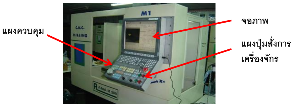
ภาพที่ 1.6 ภายนอกของชุดคอลโทรลเลอร์ (ที่มา : ฤกษ์ณพล เรื่องไฟศาล โปรแกรมเอ็นซีพื้นฐาน. 2563)
