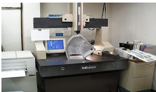
ภาพที่ 1.17 เครื่องวัดโคออร์ดิเนต (ที่มา : www.mechatronic4u.com )
